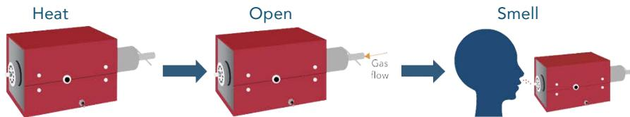
Figur 2: Der Thermal-Extractor (TE 2) liefert das im DHS extrahierte Gesamtaroma direkt aus dem Glas-Thermodesorptionsröhrchen an die menschliche Nase zur Verifizierung
