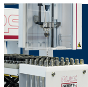
Automatisierter Linerwechsel (ALEX)
