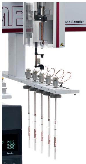
Mit dem GERSTEL- TubeSpiking-System (TSS) lassen sich normgerechte Standards für die Thermo-desorption vollautomatisiert erstellen. Fünf Adsorbens-röhrchen lassen sich in den Halterungen jedes TSS-Mod-uls befestigen und auto-matisiert mit Hilfe des MPS mit Standards beschicken. Mehrere TSS-Module kön-nen an einem MPS parallel genutzt werden.
