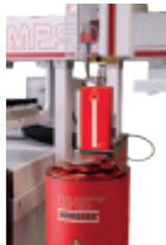
Mittels DHS-Large 3.5 lassen sich Proben in einzeln abgeschlossenen Gefäßen mit Volumina bis 1 L bei definierter Temperatur und definiertem Gasaustausch extrahieren. Der Anwender entscheidet, zu welchen Zeitpunkten die Analyten aufgefangen und auf Adsorbensröhrchen angereichert werden. Alle Schritte inklusive der nachfolgenden Thermodesorption im TD 3.5+ und GC/MS-Analyse erfolgen automatisiert.
