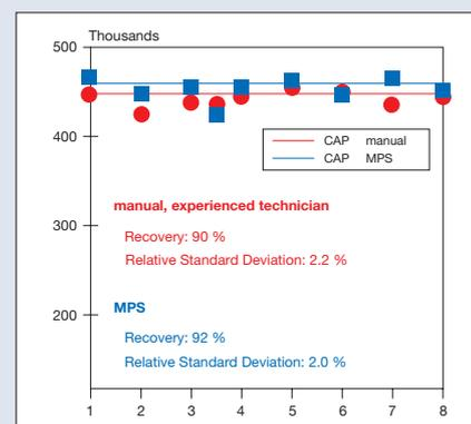
Detektion CAP (0,01 µg/kg) in Garnelenfleisch nach automatisierter SPE mit einem GERSTEL-MPS. Die Proben wurden automatisch eingengt im Verhältnis 1:10.
