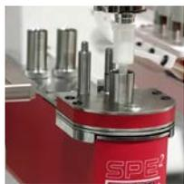
Mit der GERSTEL-SPE lässt sich die Festphasenextraktion mit Standard-SPE-Kartuschen, die mit GERSTEL-Transportadaptern versehen sind, automatisiert durchführen. Das Eluat wird nach Belieben eingedampft, das
