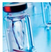
Der GERSTEL-Twister ermöglicht den Ultraspurenachweis organischer Verbindungen aus wässrigen Proben im Zuge der Stir Bar Sorptive Extraction (SBSE). Dabei werden die Analyten in der Sorbens-Ummantelung des Twisters angereichert, während er die Probe durchmischt. Ebenso kann der Twister in der Gasphase eingesetzt werden. Die anschließende Thermodesorption des Twisters erfolgt voll automatisiert mit dem MPS in Verbindung mit der GERSTEL-TDU.
