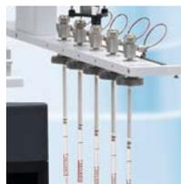
Mit dem GERSTEL-TubeSpikingSystem (TSS) lassen sich normgerechte Standards für die Thermodesorption vollautomatisch erstellen. Bis zu fünf Adsorbensröhrchen lassen sich in den TSS-Halterungen befestigen und automatisiert mit Hilfe des MPS mit Standards beschicken.
