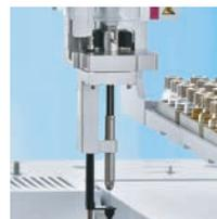
Mit dem MPS führen Sie Ihre SPME-Analytik mit 10- & 20-mm-Fasern komplett automatisiert durch – von der Konditionierung der Faser über die Probenahme bis zur Desorption und GC/MS-Analyse. Dank der
