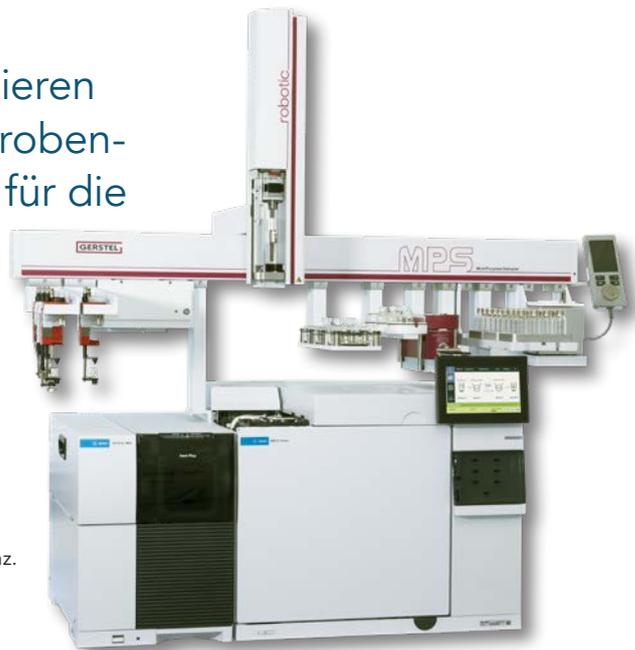
Der GERSTEL MPS robotic<sup>PRO</sup> ermöglicht die automatisierte Analyse von Proben mittels Flüssig-, Headspace- und SPME-Aufgabe in einer Sequenz.
