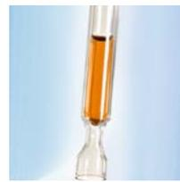
Im Zusammenspiel mit der GERSTEL-ThermalDesorptionUnit (TDU) ermöglicht der MPS die automatisierte thermische Extraktion fester und flüssiger Proben. Matrixbelastete oder viskose Proben werden automatisch in Microvials injiziert und in der TDU thermisch extrahiert. Die schmutzigen Microvials werden entsorgt und Ihr GC/MS-System bleibt sauber.
