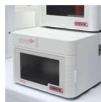
GERSTEL-SPE<sup>XOS</sup> erweitert das Probenvorbereitungsportfolio um die Möglichkeit der Online-SPE mit auswechselbaren Kartuschen. Dank geringer Sorbensmenge wird weniger Probe benötigt, weniger
