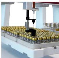
Durch das Zusammenspiel von MPS und MAESTRO-Software lassen sich alle Schritte der Probenvorbereitung einfach und effizient automatisieren und kombinieren. Unter anderem ermöglicht der MPS:
