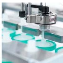
Sind Proben mit Partikeln belastet, kann dies die Probenvorbereitung erschweren oder zu einer Kontamination des GC-Liners führen. Abhilfe schafft der MPS mit der Möglichkeit, Proben unter Verwendung von Spritzenfiltern aller gängigen Größen zu filtrieren.
