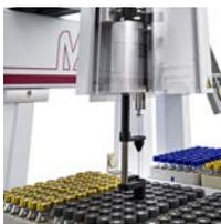
Jede MPS-Variante beherrscht die Flüssiginjektion inklusive Sandwich- und Large-Volume-Injektionen (LVI) von bis zu 1000 µL und mehr – optimal abgestimmt auf das GERSTEL-KaltAufgabeSystem KAS. Eine verschleppungs- und diskriminierungsfreie GC-Analytik steht Ihnen per Mausklick zur Verfügung.
