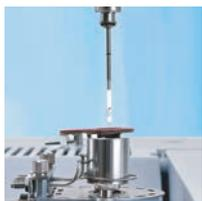
Die Pyrolyse-Option (PYRO) für die TDU und den MPS ermöglicht es, flüssige und feste Proben automatisiert zu pyrolysieren. Neben der Pulsed-Pyrolyse mit schnellstmöglicher Aufheizung steht der temperaturprogrammierte Betrieb ebenso zur Verfügung wie die Betriebsmodi: Fraktionierte Pyrolyse, sequentielle Pyrolyse und EGA (Evolved Gas Analysis)-Simulation. Der Wechsel zwischen Standard-TDU-Funktion und Pyrolyse erfordert nur wenige Minuten.
