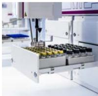
Durch das Zusammenspiel von MPS und intuitiver MAESTRO-Software-Steuerung lassen sich alle Schritte der Flüssig-Probenvorbereitung einfach und effizient automatisieren und kombinieren. Unter anderem
