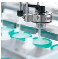
Sind Proben mit Partikeln belastet, kann dies moderne LC-Säulen schädigen. Abhilfe schafft der MPS mit der Möglichkeit, Proben unter Verwendung von Spritzenfiltern aller gängigen Größen zu filtrieren. So
