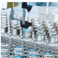
Der MPS steht für maximale Produktivität: Die PrepAhead-Funktion der MAESTRO-Software ermöglicht es Ihnen, Inkubations- und Analysezyklen intelligent zu verschachteln und Ihr GC/MS-System optimal zu nutzen. Verschleppungen vermeiden Sie dank beheizter Spritzen und Spülen mit Inertgas. Für die optimale Headspace-Analytik stehen Trays und Agitatoren für Probengefäße bis 100 mL zur Verfügung.
