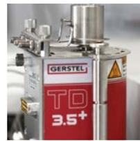
In Verbindung mit der GERSTEL-ThermalDesorptionUnit (TDU 2) oder dem ThermalDesorber TD 3.5+ für 3,5 Zoll und GERSTEL-Plus-Adsorbensröhrchen kann der MPS bis zu 240 Adsorbensröhrchen automatisiert desorbieren, beispielsweise für die Luftanalytik oder in Verbindung mit der dynamischen Headspace (DHS). Für die Thermodesorption bietet der MPS robotic ein Maximum an Möglichkeiten und höchste Flexibilität.
