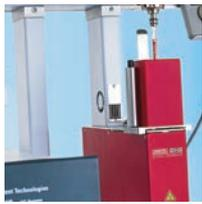
Mit der DHS steigern Sie die Effizienz Ihrer Headspace-Analyse signifikant. Der Dampfraum über festen, viskosen oder flüssigen Proben wird mit Inertgas gespült; die darin enthaltenen Analyten werden in einem auswechselbaren Adsorbensröhrchen angereichert. Die anschließende Desorption in der GERSTEL-ThermalDesorptionUnit (TDU) sowie die GC/MS-Analyse erfolgen vollautomatisch. Mit der GERSTEL-DHS verbessern Sie Nachweisgrenzen und Reproduzierbarkeit Ihrer Analytik.
