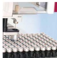
ITSP® (Instrument Top Sample Preparation) ist eine patentierte Technik zur mikroskalierten Festphasenextraktionstechnik (SPE), die vom MPS vollständig unterstützt wird.
